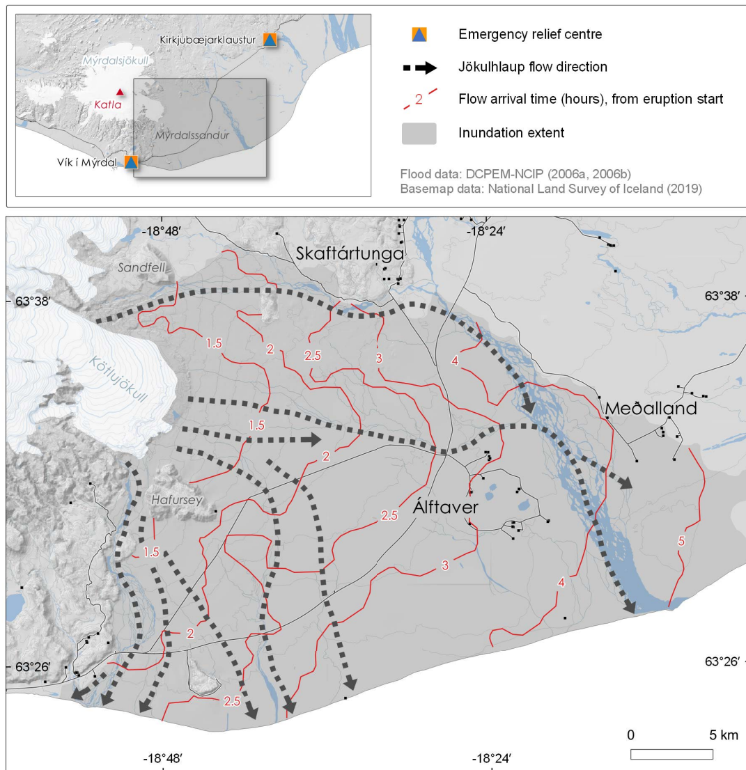
Figure 5. Inundation extent, main flow directions and minimum flow arrival times after the start of a Katla caldera eruption, according to map and brochure published by DCPem-NCIP (2006a,b). Jökulhlaups of peak discharge 300,000 \text{ m}^3/\text{s} , surging from Kötlujökull onto Mýrdalssandur were considered (see scenario specifications in Table 2). Scenario outputs were mashed by DCPem-NCIP to produce a conservative reference for the contingency planning. Regional location is shown in Figure 1. – Jökulhlaup á Mýrdalssandi af völdum eldgosa í öskju Kötlu. Flóðasvæði, meginrennislisleiðir flóðvatns og lágmarks ferðatími flóðbylgju frá upphafi goss í klukkustundum talið. Byggt á korti og bæklingi útgefið af Almannavörnum (DCPem-NCIP, 2006a,b). Á kortinu og bæklingnum voru niðurstöður sviðsmyndanna steiptar saman og útkoman notuð sem viðmið við gerð rýmingaráætlunar. Í sviðsmyndum var hámarksrennsli jökulhlaupa fram Mýrdalssand miðað við 300.000 \text{ m}^3/\text{s} (sjá töflu 2).
