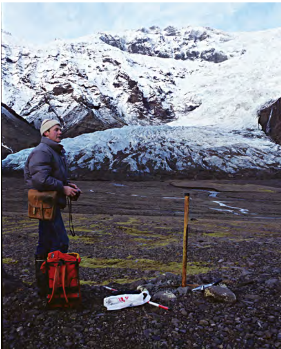
10. mynd. T.v. Helgi Torfason við mælingar á Brókarjökli, jöklamerki á járnstöng. Ljósmynd/Photograph: Oddur Sigurðsson, 3. nóvember 1989. T.h. Bergur Pálsson og Steinn Bergsson við sama merki rúmlega 20 árum síðar. Ljósmynd/Photograph: Bergur Pálsson 23. október 2010. – Left: Helgi Torfason measuring the position of terminus of Brókarjökull, glacier reference point marked with an iron pole in the foreground. Right: Bergur Pálsson and his son by the same reference point some 20 years later.
