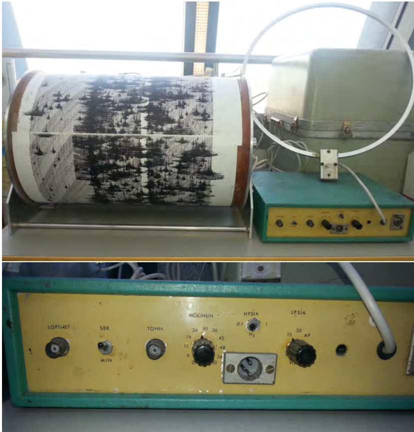
Figure 2. Top: The Landsnet seismograph. Drum recorder with a sheet showing a local recording of an earthquake swarm in the Hengill area, electronics box, and a loop antenna for the reception of the time signal. The grey box was used for the field version of the seismograph. Below: The front of the electronics box: Input for the time signal antenna, seconds filter, tone input for FM modulated signals from a signal receiver, amplifier 0–60 dB, HP-filter, input for geophone signal, LP-filter, 220 VAC power cord, 12 VDC power input. – Efri mynd: Jarðskjálftamælir Landsnetsins sem hannaður var og smíðaður á Raunvísindastofnun Háskólans. Á tromlunni er skjálftarit frá mælinum við ÍR-skálann sem sýnir jarðskjálftahrinu á Hengilssvæðinu. Einnig má sjá „græna kassann“ sem hýsir rafeindabúnaðinn og hringloftnet til móttöku á tímamerki. Grái kassinn í bakgrunninu var notaður fyrir mælinn þegar mælingar voru gerðar utanhúss. Neðri mynd: Framhlið rafeindakassans: Tengi fyrir tímamerkjaloftnet, sekúndusía, tengi fyrir tón frá móttökutæki þegar skjálftamerki var sent frá fjarlægum mæli, magnari 0–60 dB, háhleyphisía, tengi fyrir merki frá skjálftanema, lághleyphisía, snúra fyrir 220 VAC rafmagn, tengi fyrir 12 VDC rafmagn.
