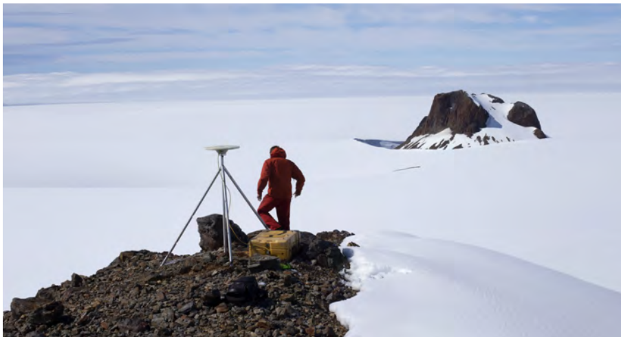
Eyjólfur Magnússon hugar að GPS-tæki á Húsbónða, Pálsfjall í baksýn. Ljósmynd/ Photo: Hrafnhildur Hannesdóttir, 3. júní 2020. – Eyjólfur Magnússon testing the GPS instrument on Húsbónði, Pálsfjall in the background.
