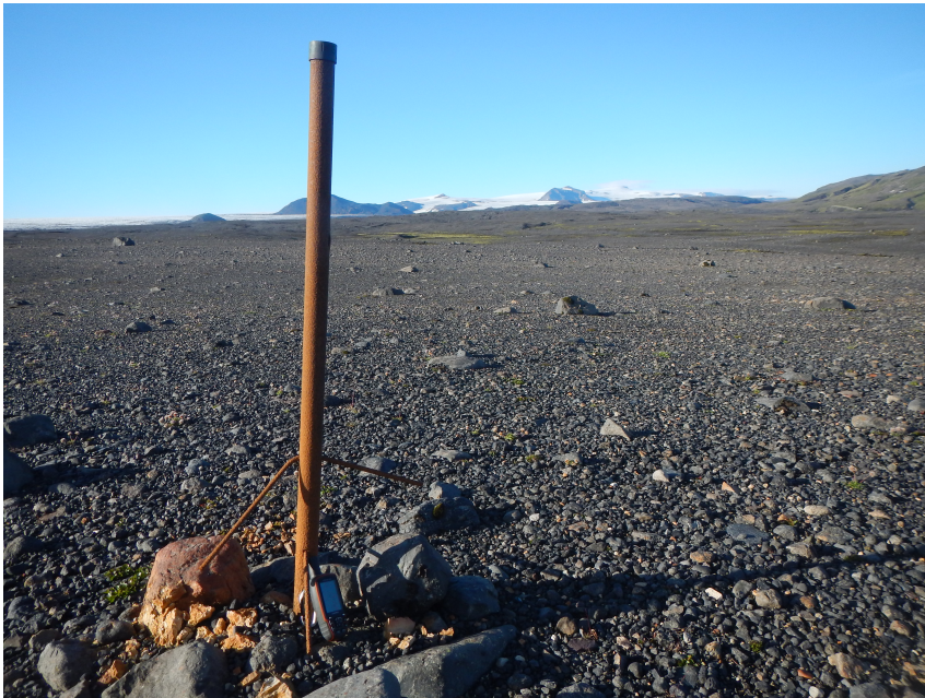
Jöklamerki 176 framan við Síðujökul. Austurhluti Síðujökuls, Hágöngur, Geirvörtur og Þórðarhyrna sjást í baksýn. – An iron rod reference point for the measurements of front variation of Síðujökull. The eastern part of Síðujökull and the mountains Hágöngur, Geirvörtur and Þórðarhyrna are in the background. Ljósmynd. /Photo: Hlynur S. Pálsson, 6. ágúst, 2016.
