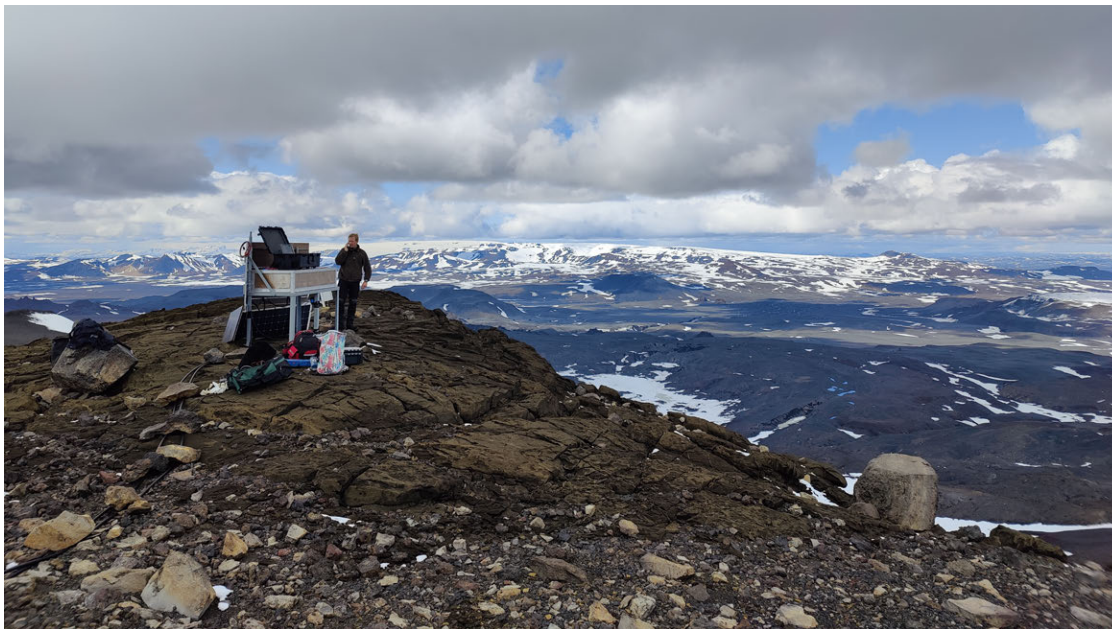
Jarðskjálftamælir á Kistu vestan við Bárðarbungu, Tungnafellsjökull í baksýn. – A seismometer at Kista, west of Bárðarbunga, with Tungnafellsjökull in the background. Ljósmynd. Hrafnhildur Hannesdóttir.
