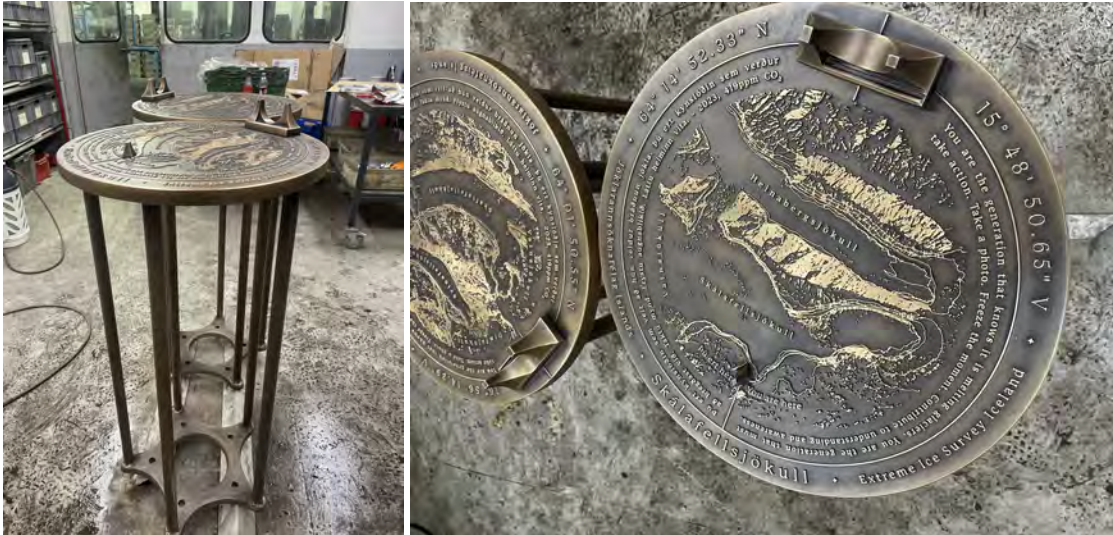
1. mynd. Sjónskífur á verkstæði Málmsteyppunnar Helli. Skífurnar eru steypar úr bronzi og sýna næsta umhverfi, auk skýringartexta. Á hverri skífu er símafesting fyrir staðlaða myndatöku af sjónarhorninu. – View discs at Hella's metal casting workshop. The discs are cast from bronze and show a map of the surroundings of each location. Each disc has a phone mount allowing photographs to be taken from a standard angle. Mynd./Photo: Grétar Þorvaldsson, 17. október 2023.
